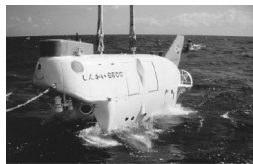
しんかい6500 日本の深海探査艇 (しんかいたんさてい) 6500メートルまで 深く潜れます
